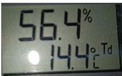
7. ábra. A 6. ábrán lévő légállapothoz tartozó harmatponti hőmérséklet (td dewpoint)
