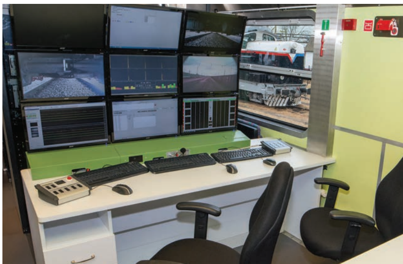
10. ábra. FMK-008 síndiagnosztikai mérővonat mérőterme
