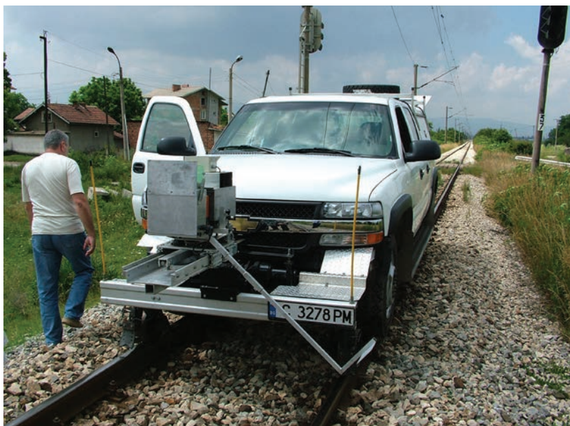
7. ábra. A Bolgár Vasúti Infrastruktúra (NK Zh) lézeres űrszelvénymérő kételtű járműve. Szófia, 2004
